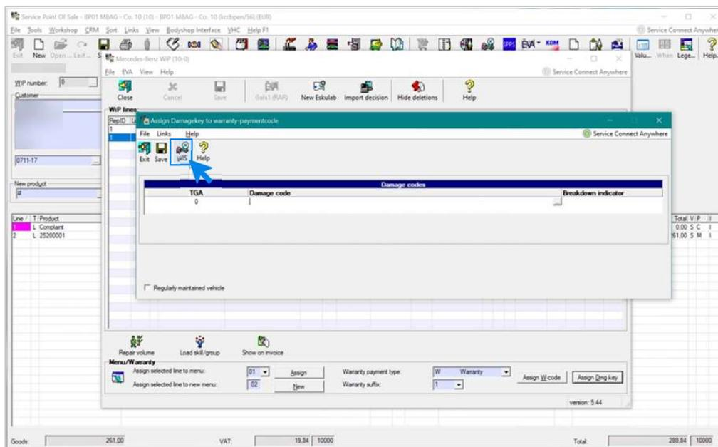
ディーラ管理システム (DMS) への故障コードの追加は、Damage Codeアプリケーションから行います。Damage Codeアプリケーションに移動するには、WISボタンをクリックしてログインします。
