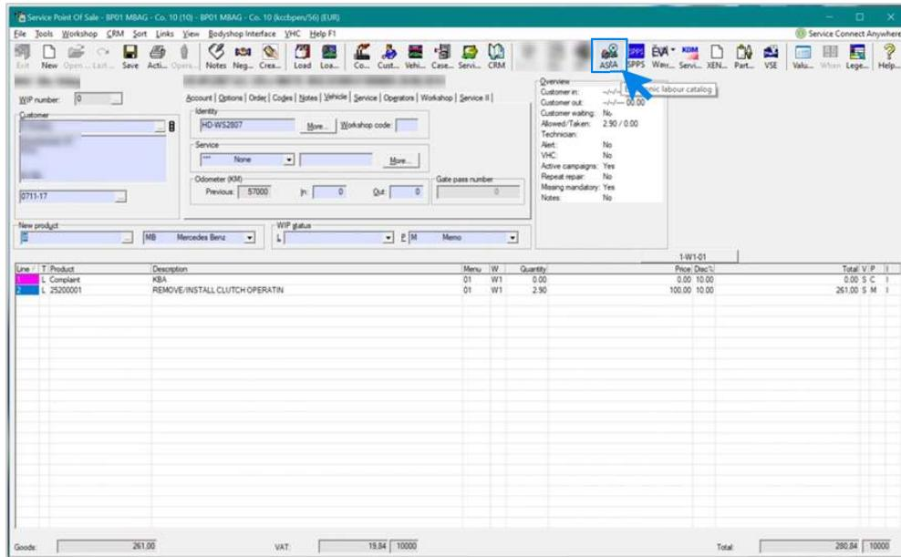
Dodajanje [delovnih postavk](#) v sistem DMS (Dealer-Management-System) poteka prek aplikacije [XENTRY Operation Time \(XOT\)](#). Če želite, da vas preusmeri na sistem XOT, kliknite gumb **ASRA**.
